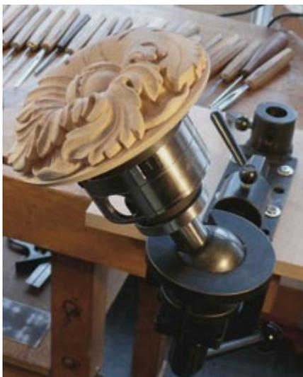
Le pied à rotule peut être orienté et fermement bloqué dans n'importe quelle position, ce qui fait de cet étau un système de serrage très polyvalent.
